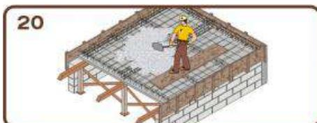
Al colar repartir el concreto del centro hacia los extremos de la losa. No formar masas de concreto.
