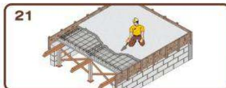
Dos horas después de iniciado el colado se recomienda aplanar, nivelar y afinar el acabado de la losa.
