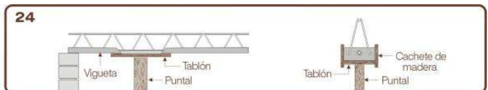
Pueden recuperarse siempre y cuando el acero longitudinal no se haya roto. Para reparar primero retire el concreto dañado, enderece el acero a su posición original y apuntale bajo la fractura.
