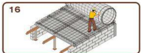
Colocar la malla electrosoldada de acuerdo al calibre especificado en el peralte de la losa a utilizar.
