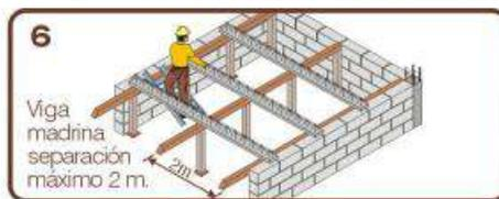
Se deben montar las viguetas con una separación de 70 cm. a ejes, de acuerdo al plano o croquis de colocación.
