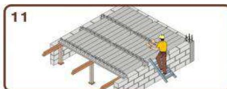
Utilizar las bovedillas con tapa en perímetro. Hacer las instalaciones sanitaria, hidráulica y eléctrica necesarias.
