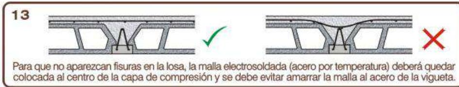
Para que no aparezcan fisuras en la losa, la malla electrosoldada (acero por temperatura) deberá quedar colocada al centro de la capa de compresión y se debe evitar amarrar la malla al acero de la vigueta.
