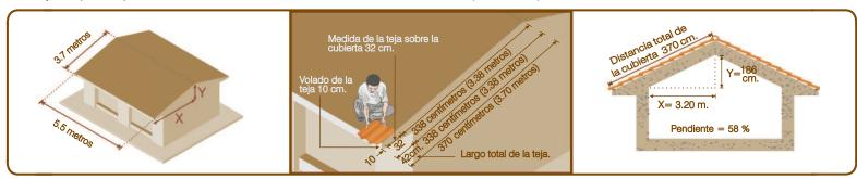
También requerimos determinar el porcentaje que tiene la pendiente de nuestra cubieta para obtener el traslape longitudinal. Para obtener este porcentaje, necesitamos dividir la altura de la cubierta en centímetros (y) entre la longitud horizontal del ancho de nuestra cubierta en metros (X), para la cubierta que estamos ejemplificando la operación queda de la siguiente manera.
