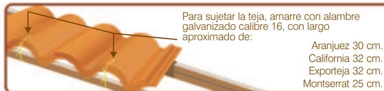
Para sujetar la teja, amarre con alambre galvanizado calibre 16, con largo aproximado de:
